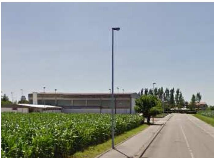
Si tratta di una linea con pali in metallo, cavi di alimentazione interrati con lampade SAP da 100 watt.
