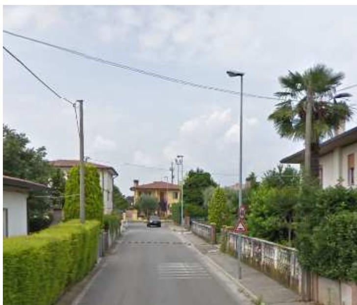
Si compone di pali in metallo, linea di alimentazione Trifase interrata con lampade SAP da 100 watt e a mercurio da 125 watt da sostituire quanto prima. La linea risulta avere una interdistanza tra pali mediamente adeguata ai dettami della L.R. 17/09.
