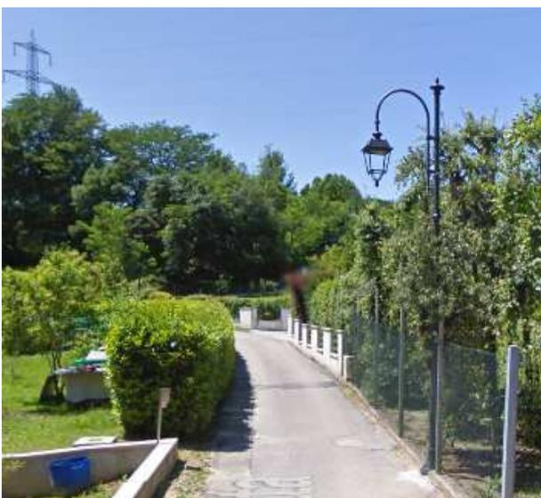
La linea risulta recentemente adeguata con sorgenti SAP da 100 watt, con apparecchi non disperdenti oltre il piano orizzontale, conforme alla L.R. 17/09. L'interdistanza tra i pali risulta mediamente adeguata – quando non superiore - al rapporto 3,7 suggerito dalla L.R. 17/09.
