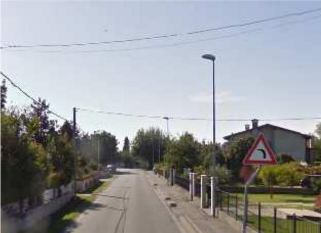
Linea recente in alimentazione trifase con lampade SAP da 100 watt in armature con vetro piano non disperdenti oltre il piano orizzontale, quindi conformi ai dettami della L.R. 17/09.
