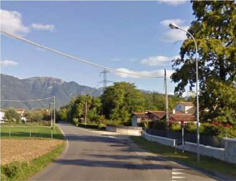
Si tratta di una linea datata con pali in metallo, cavi di alimentazione interrati con lampade al mercurio da 125 watt.
