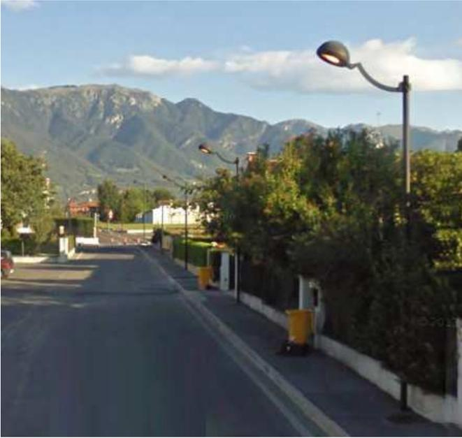
Linea che comprende principalmente apparecchi a vetro piano di moderna concezione da orientare parallelamente al piano orizzontale. La linea è dotata di lampade SAP da 70 e 100 watt. La linea risulta avere una interdistanza tra pali mediamente inferiore alle prescrizioni della L.R. 17/09.
